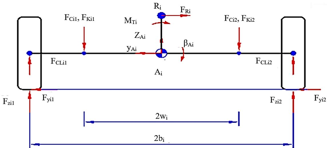
Fig. 3. Model of unsprung masses
