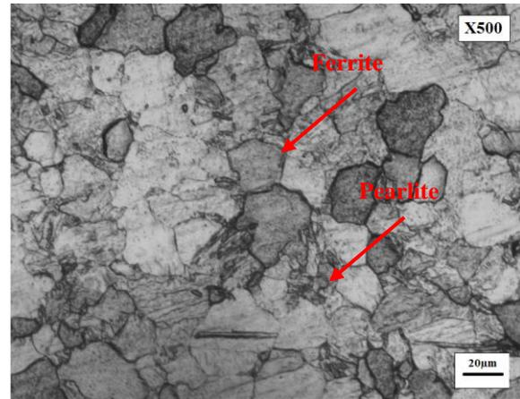
(d) Sample heated at 700  $^{\circ}\text{C}$
