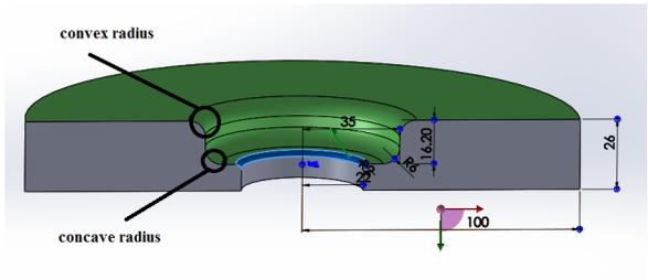
Fig. 5. Hydrostatic die
