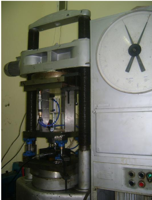
**Fig. 12.** 125-ton hydraulic press
