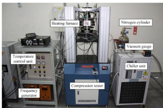
**Fig. 7.** Hot embossing apparatus
